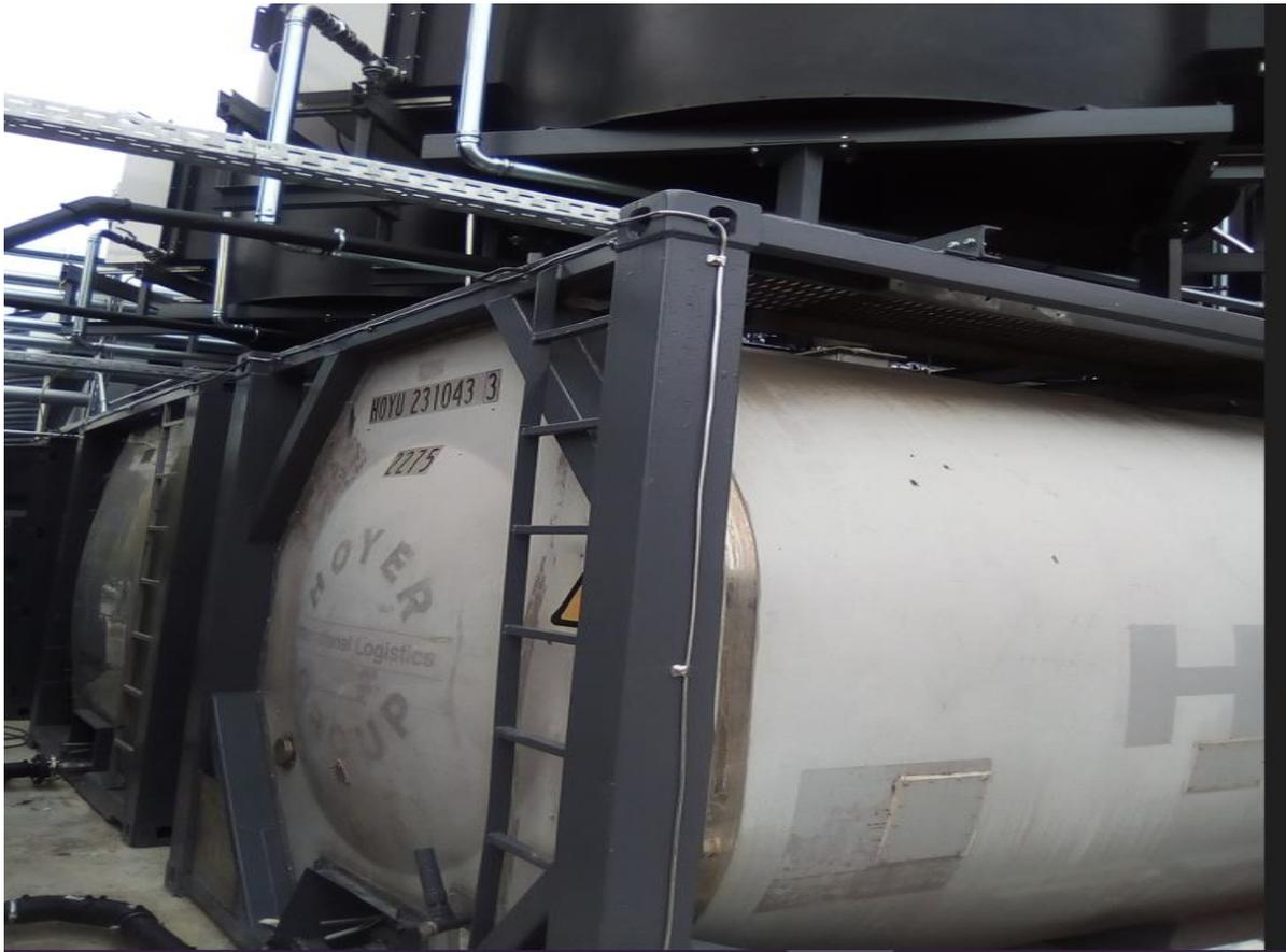
Unterbautank einer Aufkonzentrationsanlage. Über den Produktionstanks stehen die Rieslerbehälter mit den Ersatzkaminen, über die die mit Wasserdampf beladene Luft in die freie Luftströmung abgegeben wird. Die Produktionstanks sind mit einer Flüssigkeitswaage zur permanenten Konzentrationsbestimmung mit Sichtanzeige ausgerüstet.
