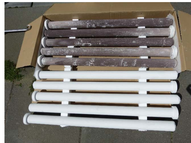
Abb.: 8: Filterkerzen nach Versuch mit Klärschlammasche (oben) und neue Kerzen (unten)
