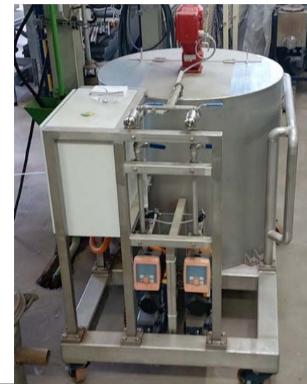
Abb. 10: Übersicht Additivdosierung VERENA
