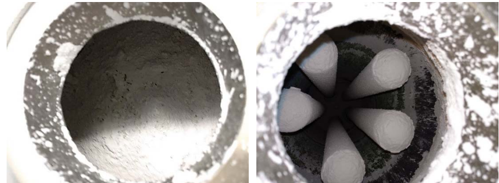
Abb.: 7 Agglomerierter und abgereinigter Staub
