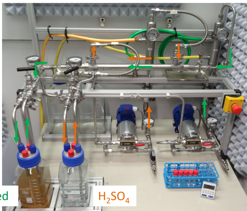
Technikumsanlage zur Membranextraktion (Q bis 700 L/h)
