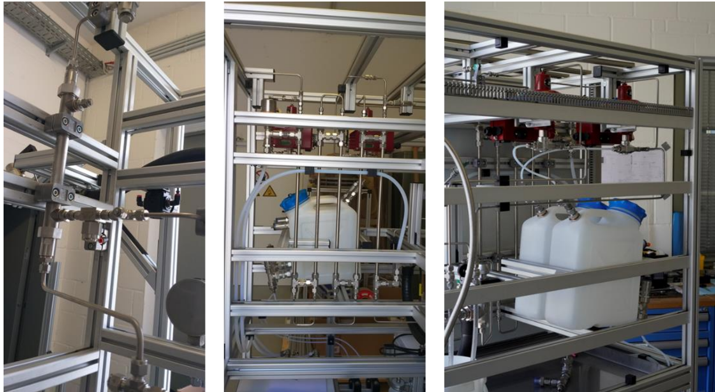
Links: Membranmodul; Mitte: Kühler; Rechts: Regelventile und Behälter (Quelle: DBFZ)
